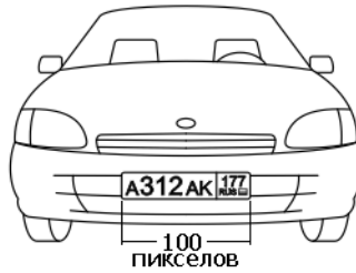
Рис. 3. Настройка фокусного расстояния
